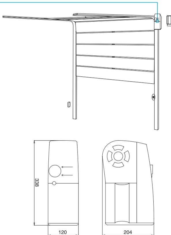
**NOTA** En caso de puertas seccionales superiores a 22 m<sup>2</sup> y de hasta 34 m<sup>2</sup> es necesario el uso del kit VISCH.
